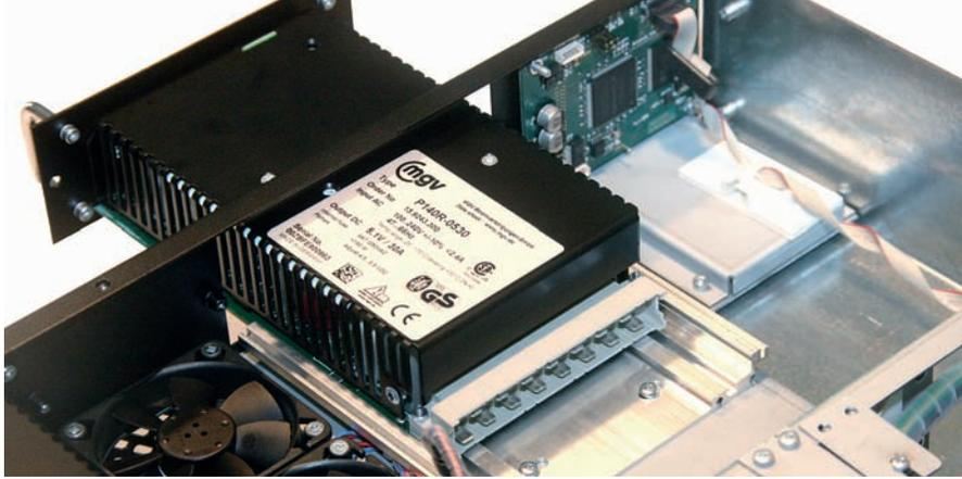
Horizontal montiert, passen die redundanzfähigen 3-HE-Netzteile auch in flachere 19-Zoll-Gehäuse.
